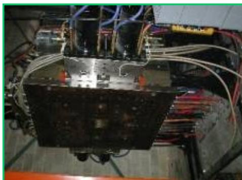
Les bouchons broyés sont fondus à haute température et arrivent dans des moules
